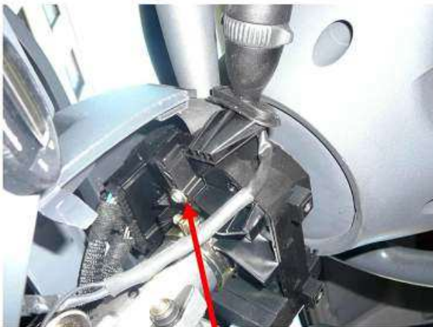
Kytkimen kiinnitys yhdellä "sopivalla" ruuvilla auton valokytkimeen
