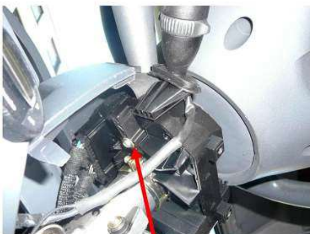
Kytkeyn kiinnitys yhdellä "sopivalla" ruuvilla auton valokytkeyn
